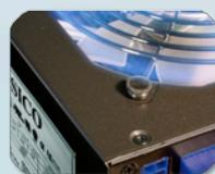
Vibrationsgedämpfte Lüfteraufhängung und Design-Lüfter mit integrierter blauer LED
